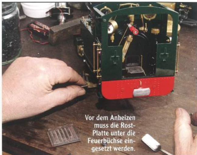
Vor dem Anheizen muss die Rost-Platte unter die Feuerbüchse eingesetzt werden.
