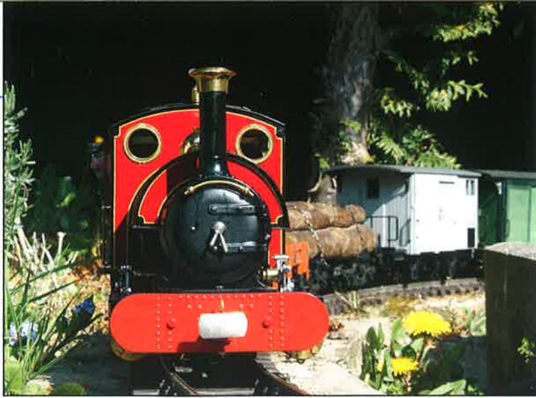
Nach der letzten Ausfahrt wird die Lok mit Autowaschmittel und einem weichen Pinsel gereinigt, damit die feinen scharfen Kohlepartikel keine Kratzer im Lackkleid hinterlassen.
